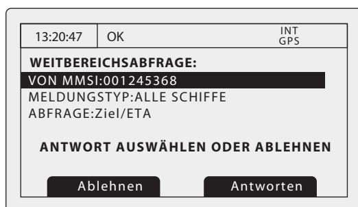
Abbildung 19 Benachrichtigung zur Weitbereichsabfrage: manuelle Antwort
