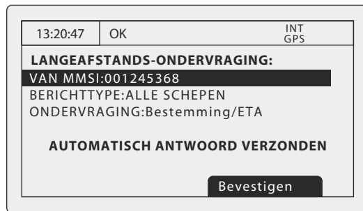
Afbeelding 18 Melding langeafstands-ondervraging; automatische antwoordmodus ingeschakeld
