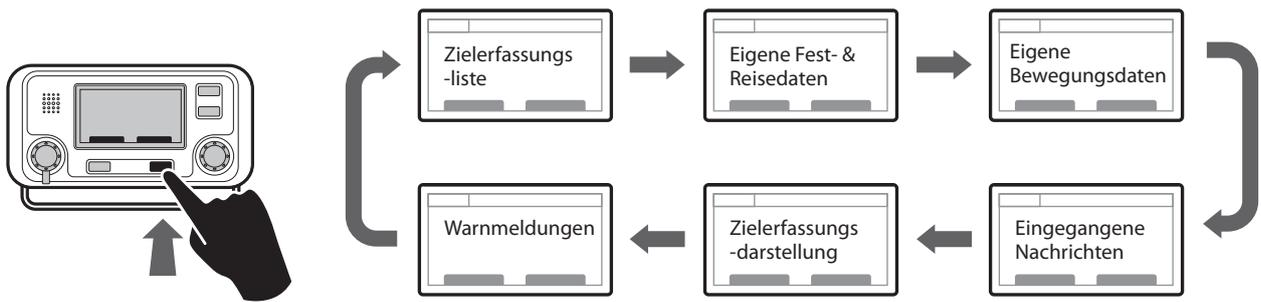
Im normalen Betrieb zeigt das Display einen von sechs Hauptbildschirmen für die Bedienung an. Der nächste Bildschirm kann jederzeit durch Drücken der Funktionstaste Screen (Bildschirm) ausgewählt werden.
